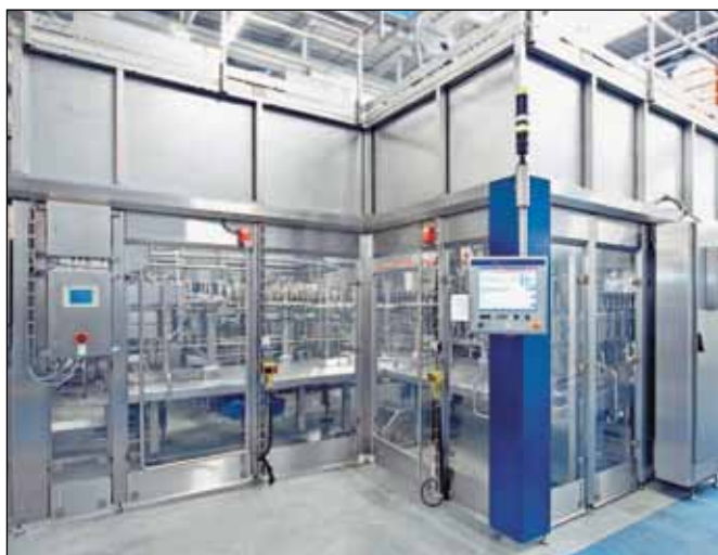
Блок «чистого помещения» для линий розлива вина
